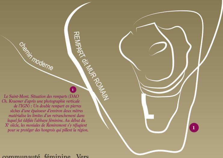
1 Le Saint-Mont. Situation des remparts (DAO) Ch. Kraemer d'après une photographie verticale de l'IGN : Un double rempart en pierres sèches d'une épaisseur d'environ deux mètres matérialise les limites d'un retranchement dans lequel fut édifiée l'abbaye féminine. Au début du X<sup>e</sup> siècle, les moniales de Remiremont s'y réfugient pour se protéger des hongrois qui pillent la région.
